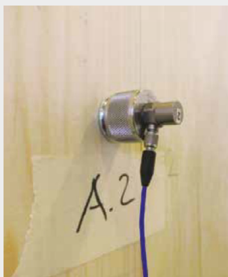
Prüfkonfiguration der Schallübertragung an einer vertikalen X-Verbindung
